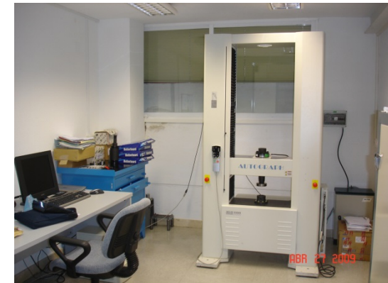
Máquina Generadora de Fuerza (1 kN / 10 kN / 100 kN)
